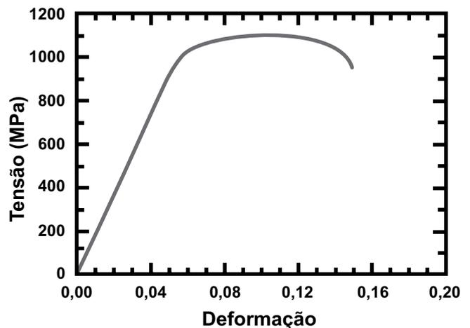
27. Com base no diagrama tensão-deformação, o módulo de elasticidade do material é:
