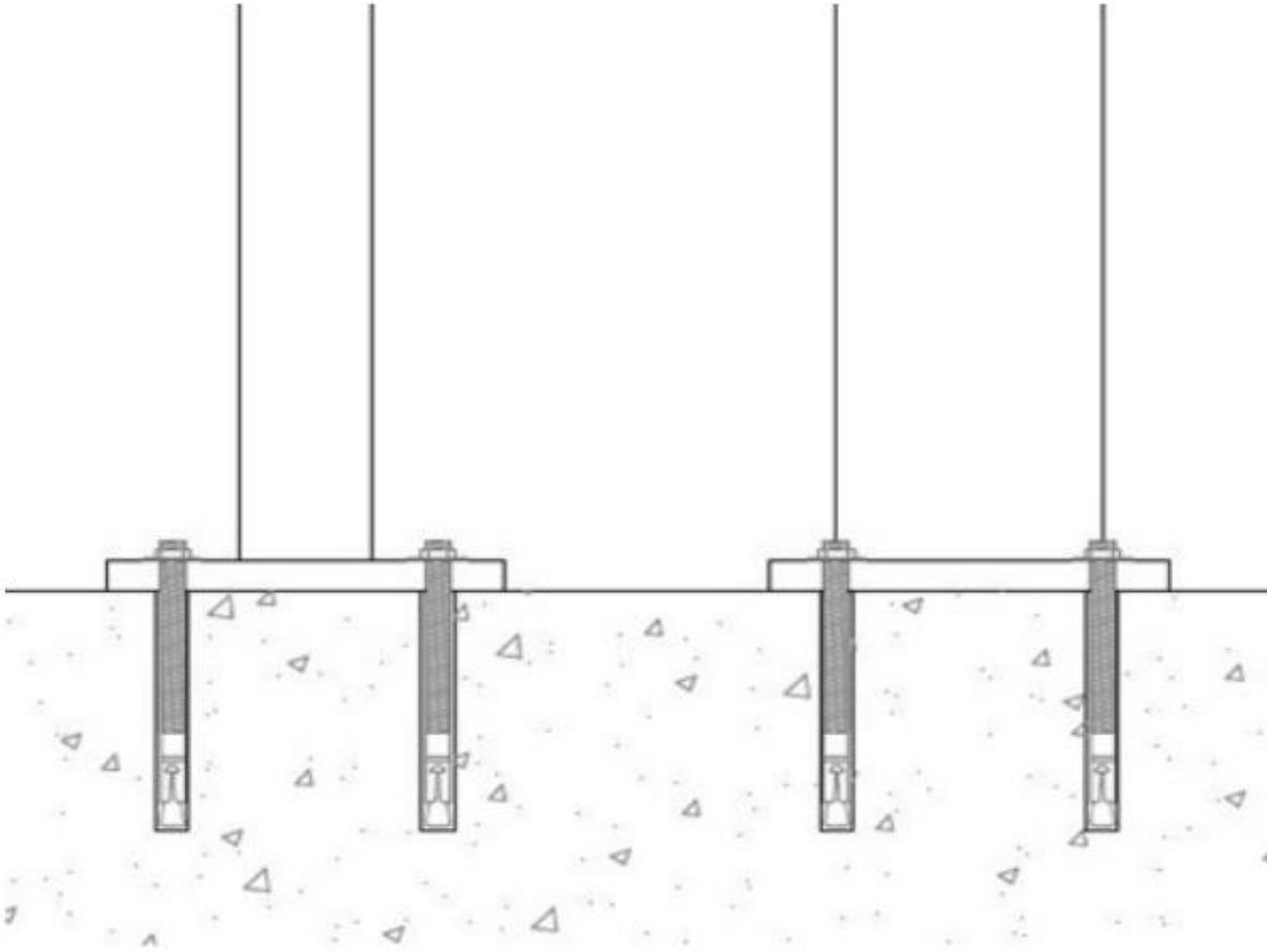
Figura 2 - Detalhe de fixação do montante na base (chumbador mecânico)
